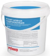
Сухая гидроизоляционная смесь. Для герметизации и заполнения стыков, швов, неактивных трещин бетонных, железобетонных, кирпичных и каменных конструкций, а также вводов коммуникаций. На основе портландцемента, фракционированного минерального заполнителя и специальных добавок. Обладает бронирующим уплотняющим действием. Низкая проницаемость обеспечивает высокую стойкость к воздействию агрессивных сред и морской вод.
