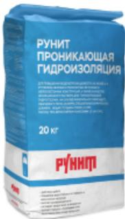
Сухая гидроизоляционная смесь. Для восстановления и повышения водонепроницаемости (не менее 2-х ступеней) сборных и монолитных бетонных и железобетонных конструкций. Может применяться в качестве инъекционного раствора для устройства капиллярной отсечки в стенах. На основе минерального вяжущего, кварцевого песка (0,63 мм) и специальных проникающих химических добавок.
