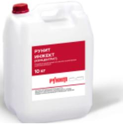
Жидкий гидрофобной инъекционный состав. Для нагнетания под давлением в кирпичную кладку и иные строительные конструкции для отсечки капиллярного подсоса. На основе смеси силанов и силоксанов. Не использовать для конструкций, находящихся под постоянным гидростатическим давлением. Может применяться для снижения водопоглощения поверхности. Не содержит растворителей.
